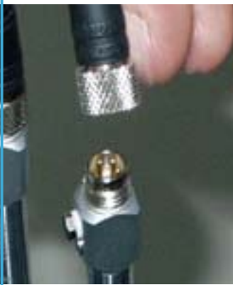
缆线和测头通过插头-接口实现分离
